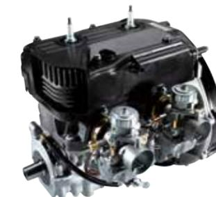
**LIBERTY 550.** Le moteur Liberty 550 est refroidi par ventilateur pour fournir une puissance constante, quelles que soient les conditions d'enneigement. Il est équipé d'un embrayage à poulie menante PowerBloc 50 et d'un embrayage à poulie menée Invance de CVTech, pour un démarrage en douceur et une manœuvrabilité améliorée à basse vitesse.
