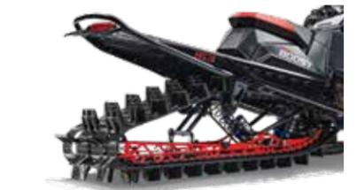
**TUNNEL CONIQUE SLASH.** Le tunnel court de forme conique réduit considérablement la résistance dans la neige. Il offre une meilleure traction et plus de maniabilité dans la neige profonde.
