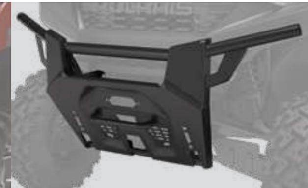
CONSTRUCTION EN TUBE D'ACIER D'UN DIAMÈTRE DE 1 3/4 po
