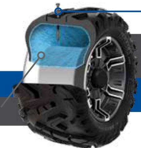
Lorsqu'une fuite se produit, le scellant pour pneu s'écoule rapidement en dehors du pneu pour créer un colmatage solide et permanent.
