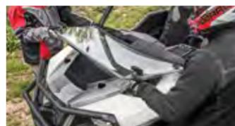
Options de pare-brise entièrement étanche ou rabattable. La moitié supérieure se détache, laissant la partie inférieure pour une protection avec aération maximale.
