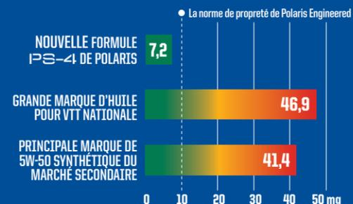
ASTM D6335. Dans des essais de tiers avec 9 produits concurrents, l'huile PS-4 de Polaris produisait moins de la moitié des dépôts par rapport au produit le plus équivalent. Aucun autre produit testé n'a atteint les normes de propreté de dépôts de Polaris Engineered.
