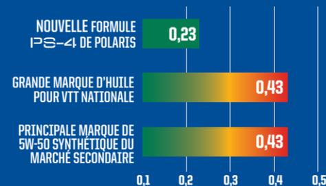
ASTM D4172. Dans des essais de tiers avec 11 produits concurrents, l'huile de Polaris offrait 40 % ou plus de protection contre l'usure par rapport à tous les autres produits testés.
